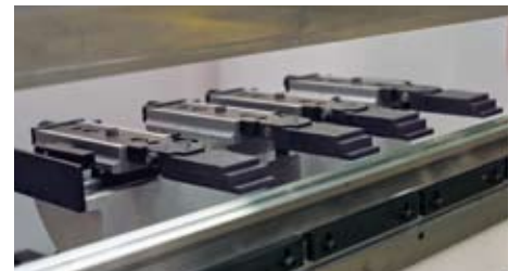
Dokunma sensörlü gezici dayama Touch sensorized finger
